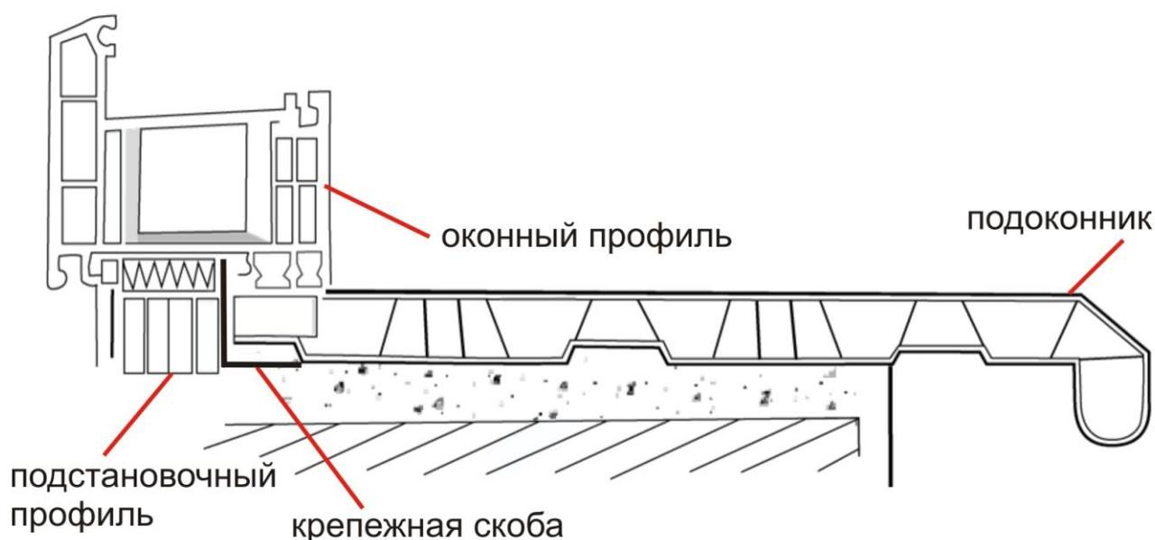
Рекомендуемое расстояние между скобами - до 500 мм, отступы от краев подоконника не должны быть более 250 мм. Шурупы и саморезы используются только после предварительного засверливания.
